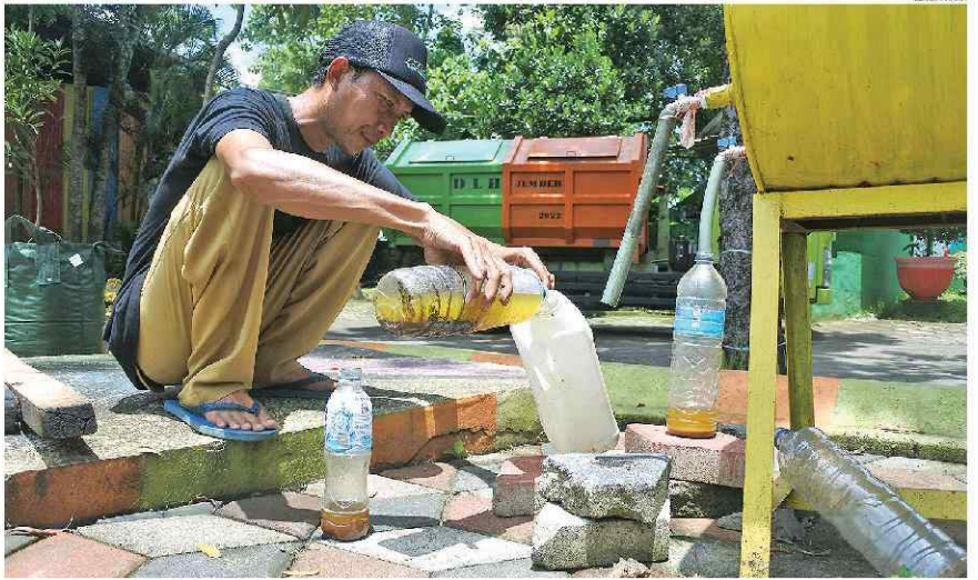
PENGOLAHAN SAMPAH PLASTIK UNTUK BAHAN BAKAR MINYAK Petugas menuang bahan bakar minyak (BBM) bensin hasil daur ulang sampah plastik di tempat pembuangan akhir (TPA) sampah Pakusari, Jember, Kamis (17/3). TPA sampah Pakusari mengolah sampah plastik 10 kg per hari menjadi BBM bensin dan solar sekitar delapan liter dengan teknik penyulingan sebagai upaya untuk pengurangan sampah plastik.
