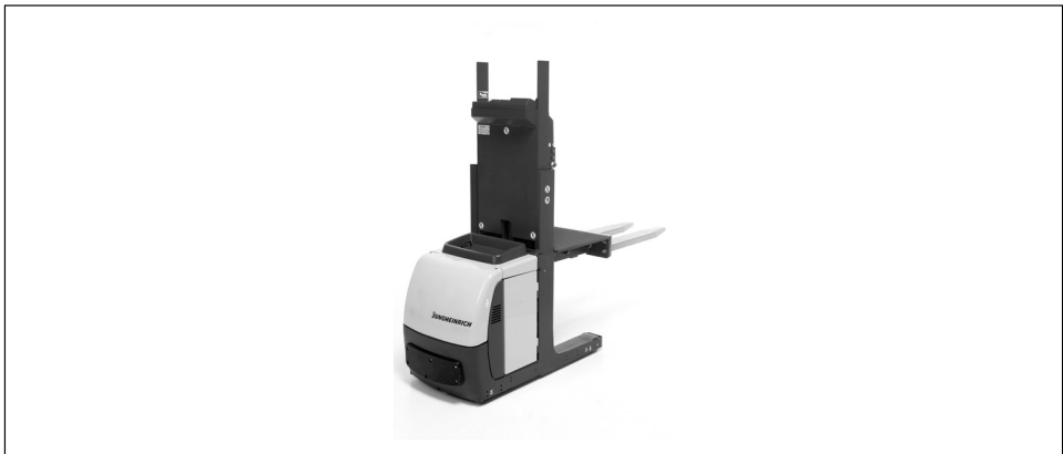
Figura 2.30. Carretilla eléctrica transportadora Ameise Teletrack, guiada por corrientes inductivas (EGU-IR).
