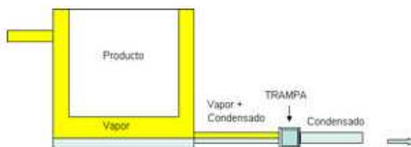
Figura No. 20. Trampa de Vapor
