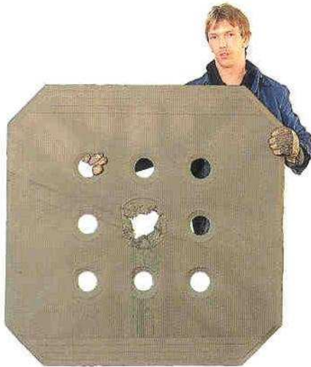
Torta típica del filtro prensa Netzsch
